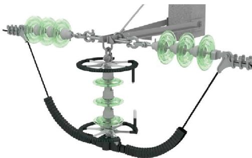
*Рисунок 22. Эскиз РМКЭ-35 на анкерной опоре с натяжной подвеской*
