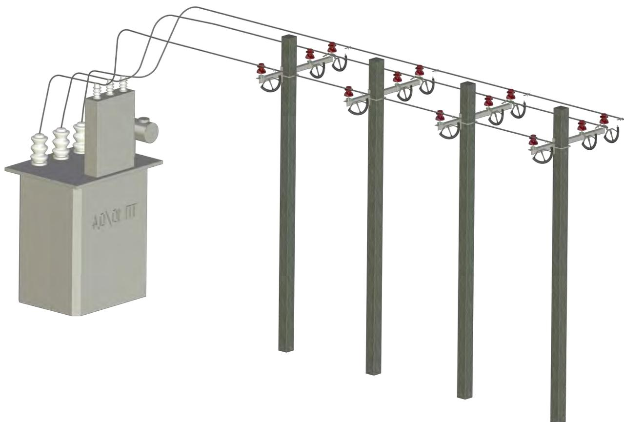
Рис. 28. Защита подходов ВЛ 6,10 кВ к подстанциям
