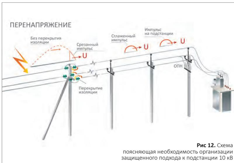
Рис. 12. Схема поясняющая необходимость организации защищенного подхода к подстанции 10 кВ
