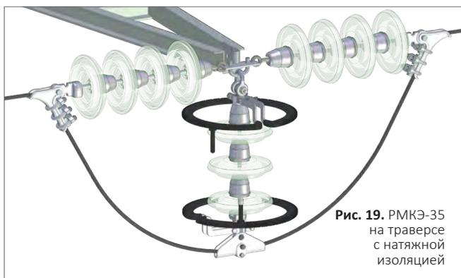
Рис. 19. РМКЭ-35 на траверсе с натяжной изоляцией
