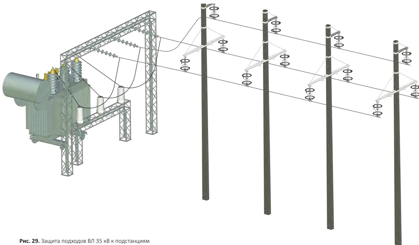
Рис. 29. Защита подходов ВЛ 35 кВ к подстанциям
