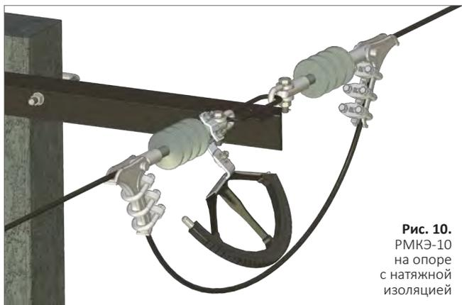
Рис. 10. РМКЭ-10 на опоре с натяжной изоляцией
