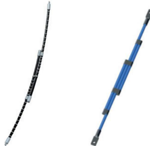
**РДИМ-10-1.5-IV-УХЛ1** защищает от ПУМ. Установка комплектов РДИМ-10-1.5-IV-УХЛ1 на ближайших к подстанции опорах позволяет предотвратить близкие к подстанции короткие замыкания из-за грозовых перенапряжений, приводящих к пагубному электродинамическому удару по обмоткам трансформаторов, что значительно увеличивает надежность их работы и срок службы.
