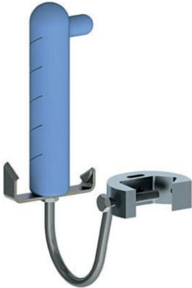
**PMK-10-И-III-УХЛ1** прост в установке, не требует технического обслуживания, выдерживает воздействие прямого удара молнии без разрушения. При прямом попадании молнии в линию электропередачи пробиваются воздушные промежутки внутри МКС, затем дуга выходит за пределы МКС и горит снаружи, не повреждая разрядник. Способен работать дольше в зонах с высокой грозовой активностью по сравнению с традиционными решениями. Обладает повышенной стойкостью к актам вандализма.
