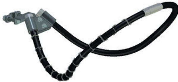
**РДИП-10-IV-УХЛ1** выдерживает прямой удар молнии без разрушения, т.к. разряд происходит снаружи аппарата, а не внутри.
