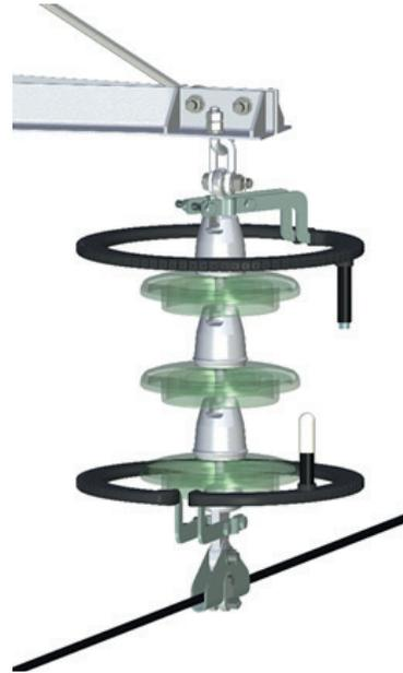
**PMKЭ-35-IV-УХЛ1** не требует замены существующей изоляции. Для монтажа разрядника на опоре с поддерживающей подвеской не требуется применение дополнительной арматуры и крепежа. Защищает от всех видов молниевых воздействий, выдерживает прямой удар молнии и защищает линию от отключения.
