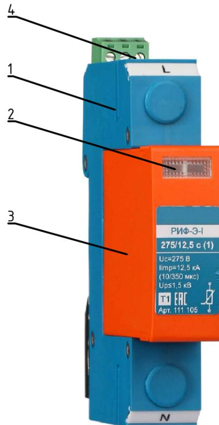
Устройство защиты от импульсных перенапряжений (УЗИП) ограничивающего типа РИФ-Э-1 275/12,5 с (1) предназначено для защиты оборудования в низковольтных цепях до 1000 В от вторичных воздействий молнии, электромагнитных наводок и коммутационных перенапряжений. Применяется в любых системах заземления. Однополюсное УЗИП класса испытаний I состоит из базы и сменного рабочего модуля. Конструктивное исполнение УЗИП предусматривает установку на стандартную DIN-рейку.
