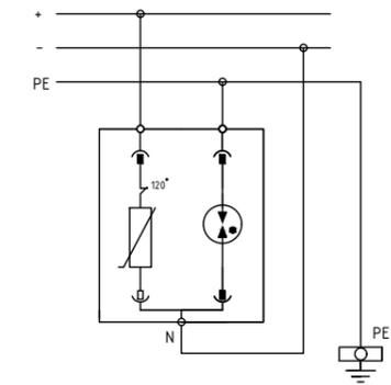
Устройство защиты от импульсных перенапряжений (УЗИП) комбинированного типа РИФ-Э-II 220=/20 предназначено для защиты оборудования в цепях постоянного тока. УЗИП класса испытаний II состоит из базы и двух сменных рабочих модулей. Рабочими элементами устройства являются варистор и газонаполненный разрядник. Рабочий модуль ограничивающего типа снабжен тепловым расцепителем и индикатором состояния. Конструктивное исполнение УЗИП предусматривает установку на стандартную DIN-рейку.
