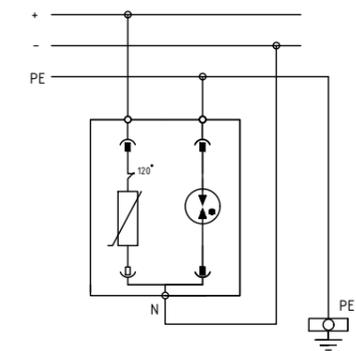
Устройство защиты от импульсных перенапряжений (УЗИП) комбинированного типа РИФ-Э-II 48=/15 предназначено для защиты оборудования в цепях постоянного тока. УЗИП класса испытаний II состоит из базы и двух сменных рабочих модулей. Рабочими элементами устройства являются варистор и газонаполненный разрядник. Рабочий модуль ограничивающего типа снабжен тепловым расцепителем и индикатором состояния. Конструктивное исполнение УЗИП предусматривает установку на стандартную DIN-рейку.
