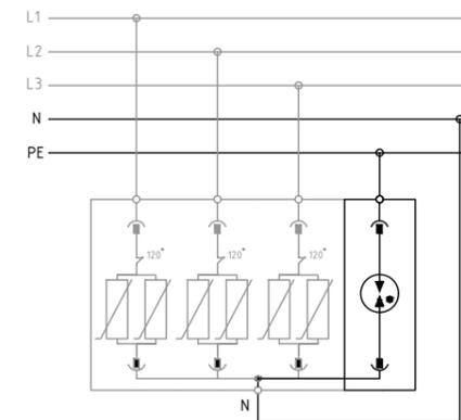
Система заземления TT
