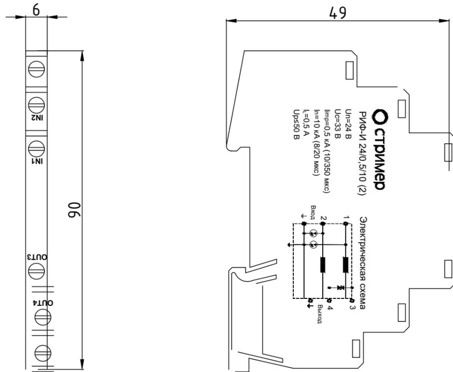
Схема подключения УЗИП РИФ-И 24/0,5/10 (2)
