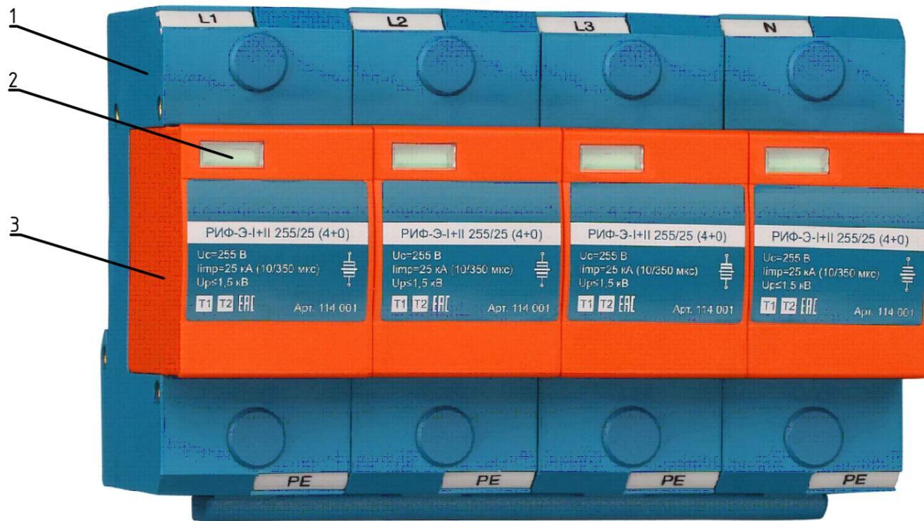
Устройство защиты от импульсных перенапряжений (УЗИП) комбинированного типа РИФ-Э-І+ІІ 255/25 с (4+0) предназначено для защиты оборудования в низковольтных цепях до 1000 В от вторичных воздействий молнии, электромагнитных наводок и коммутационных перенапряжений. Применяется для систем заземления TN-S и TT. Рабочими элементами УЗИП являются мультиэлектродные газонаполненные разрядники. Конструктивное исполнение УЗИП предусматривает установку на стандартную DIN-рейку.
