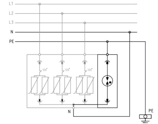
Устройство защиты от импульсных перенапряжений (УЗИП) коммутационного типа РИФ-Э-1+II 255/50 (N-PE) предназначено для защиты оборудования в низковольтных цепях до 1000 В от вторичных воздействий молнии, электромагнитных наводок и коммутационных перенапряжений. Применяется в системах заземления TN-S и TT для защиты изоляции нулевого проводника. Рабочим элементом УЗИП является мощный газонаполненный разрядник. УЗИП устанавливается на стандартную DIN-рейку
