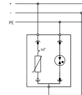
Система заземления TT
