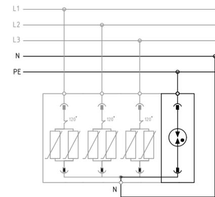
Система заземления TT
