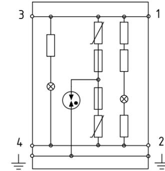
Устройство защиты от импульсных перенапряжений (УЗИП) комбинированного типа РИФ-Э-III 320/3 с (1+1) предназначено для защиты оборудования в низковольтных однофазных цепях до 1000 В от конечных бросков импульсных перенапряжений. Однополюсное УЗИП класса испытаний III выполнено в монолитном корпусе. Рабочими элементами являются варисторы и газонаполненный разрядник. Конструктивное исполнение УЗИП предусматривает установку на стандартную DIN-рейку.
