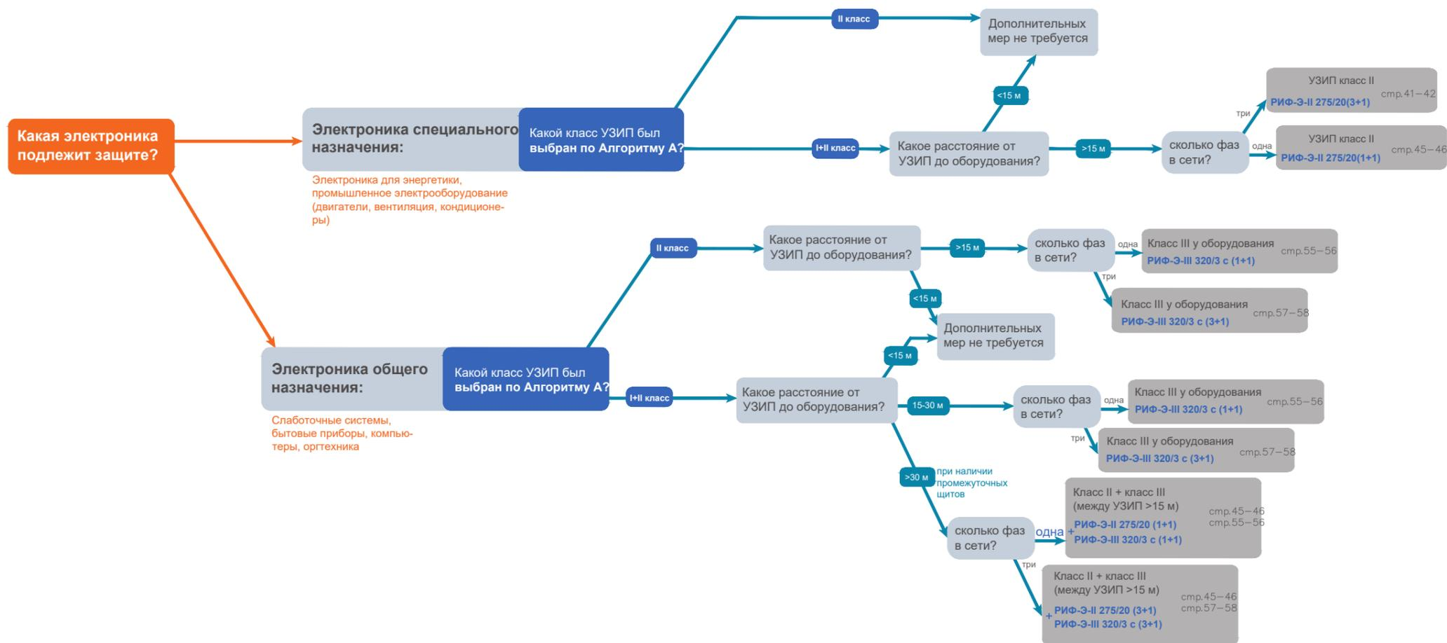
Алгоритм D поможет организовать каскадную схему защиты – выбрать УЗИП второй и, при необходимости, третьей ступеней для электроники специального и общего назначения. УЗИП для второй и третьей ступеней выбираются с учетом УЗИП, установленных на предыдущем этапе по алгоритму А.
