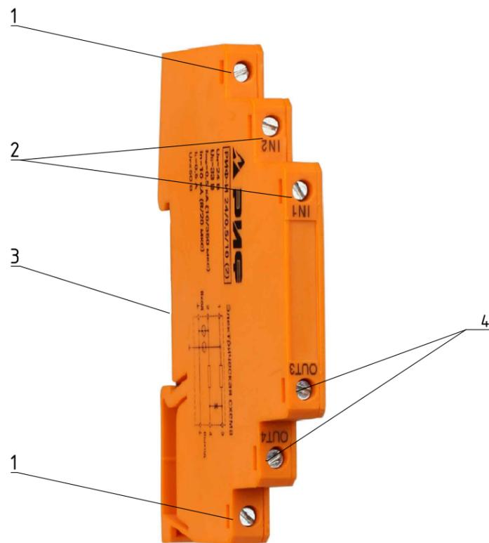
Устройство защиты от импульсных перенапряжений (УЗИП) предназначено для защиты сбалансированного интерфейса систем передачи данных, управления и измерения в соответствии с ГОСТ Р 54986-2012 (МЭК 61643-21:2009). Комбинированное УЗИП обеспечивает защиту по двухступенчатой схеме: первая ступень выполнена на газонаполненных разрядниках, вторая – на TVS- диодах. УЗИП выполнено в монолитном корпусе. Конструктивное исполнение УЗИП предусматривает установку на стандартную DIN-рейку, ширина УЗИП 6 мм.
