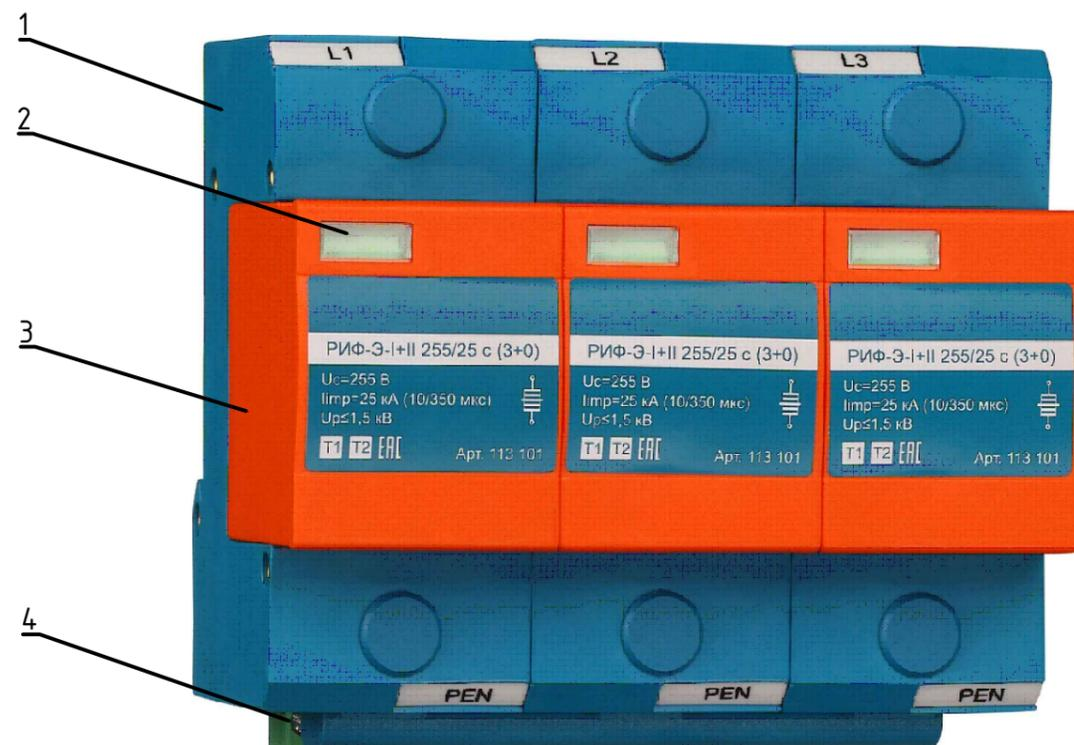
Устройство защиты от импульсных перенапряжений (УЗИП) коммутующего типа РИФ-Э-I+II 255/25 с (3+0) предназначено для защиты оборудования в низковольтных цепях до 1000 В от вторичных воздействий молнии, электромагнитных наводок и коммутационных перенапряжений. Применяется в системе заземления TN-C. Трёхполюсное УЗИП класса испытаний I+II состоит из базы и трёх сменных рабочих модулей. УЗИП устанавливается на стандартную DIN-рейку
