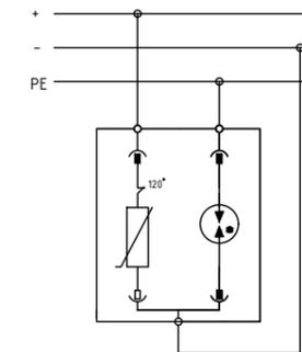
Система заземления TT
