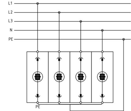
Система заземления TT
