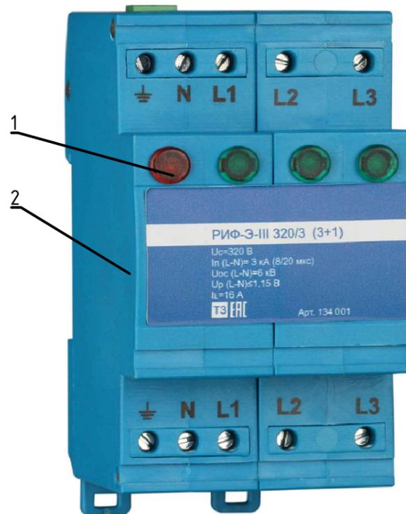
Устройство защиты от импульсных перенапряжений (УЗИП) комбинированного типа РИФ-Э-III 320/3 с (3+1) предназначено для защиты оборудования в низковольтных трехфазных цепях до 1000 В от конечных бросков импульсных перенапряжений. Рабочими элементами являются варисторы и газонаполненный разрядник. Конструктивное исполнение УЗИП предусматривает установку на стандартную DIN-рейку.
