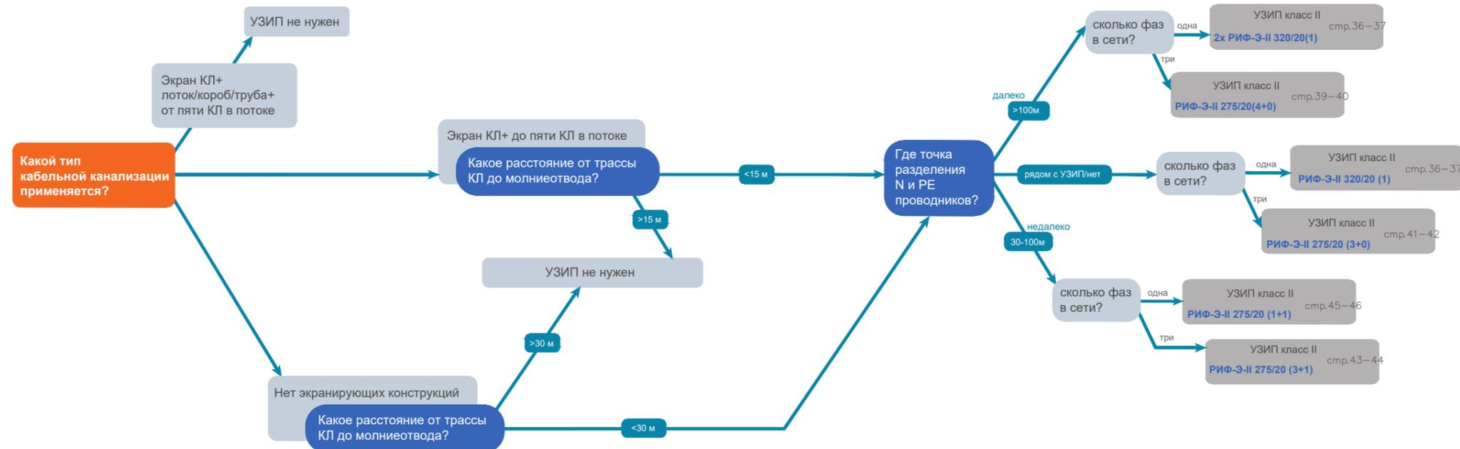
С помощью алгоритма В от наведенных (индуктированных) перенапряжений защищается оборудование, питающие линии 0,4 кВ которого проходят вблизи молниеотводов на открытой территории объекта. Типичными примерами таких объектов являются промышленные предприятия, аэропорты, заправочные станции, компрессорные станции, ОРУ подстанций (рисунок 19).
