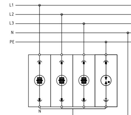
Система заземления TT
