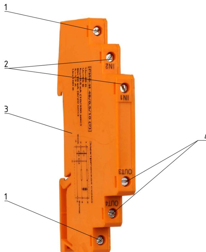
Устройство защиты от импульсных перенапряжений (УЗИП) предназначено для защиты сбалансированного интерфейса систем передачи данных, управления и измерения в соответствии с ГОСТ Р 54986-2012 (МЭК 61643-21:2009). Комбинированное УЗИП обеспечивает защиту по двухступенчатой схеме: первая ступень выполнена на газонаполненных разрядниках, вторая – на TVS-диодах. УЗИП выполнено в монолитном корпусе. Конструктивное исполнение УЗИП предусматривает установку на стандартную DIN-рейку, ширина УЗИП 6 мм
