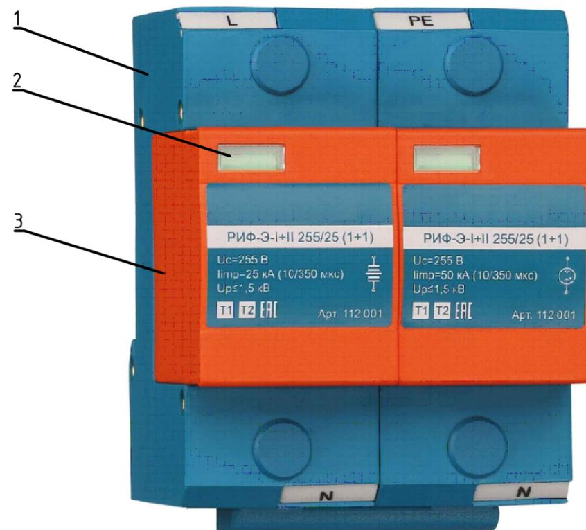
Устройство защиты от импульсных перенапряжений (УЗИП) коммутующего типа РИФ-Э-I+II 255/25 (1+1) предназначено для защиты оборудования в низковольтных цепях до 1000 В от вторичных воздействий молнии, электромагнитных наводок и коммутационных перенапряжений. Применяется в системах заземления TT и TN-S. Двухполюсное УЗИП класса испытаний I+II состоит из базы и двух сменных рабочих модулей. УЗИП устанавливается на стандартную DIN-рейку
