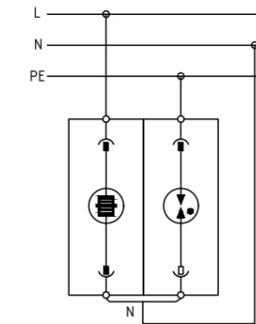
Система заземления TT
