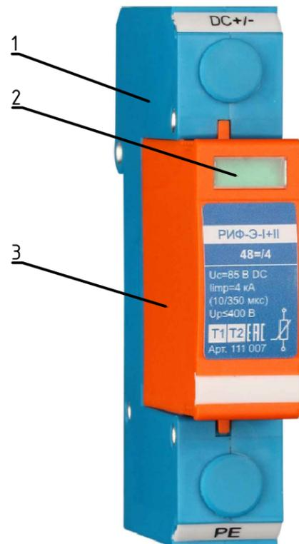
Устройство защиты от импульсных перенапряжений (УЗИП) комбинированного типа РИФ-Э-1+II 48=I/4 предназначено для защиты оборудования в цепях постоянного тока. Однополюсное УЗИП класса испытаний I+II состоит из базы и сменного рабочего модуля. Рабочим элементом УЗИП является варисторный модуль. Устройство снабжено тепловым расцепителем и индикатором состояния. Конструктивное исполнение УЗИП предусматривает установку на стандартную DIN-рейку.
