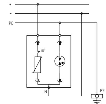
Устройство защиты от импульсных перенапряжений (УЗИП) комбинированного типа РИФ-Э-II 24=/10 предназначено для защиты оборудования в цепях постоянного тока. УЗИП класса испытаний II состоит из базы и двух сменных рабочих модулей. Рабочими элементами устройства являются варистор и газонаполненный разрядник. Рабочий модуль ограничивающего типа снабжен тепловым расцепителем и индикатором состояния. Конструктивное исполнение УЗИП предусматривает установку на стандартную DIN-рейку.
