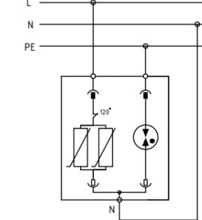
Система заземления TT
