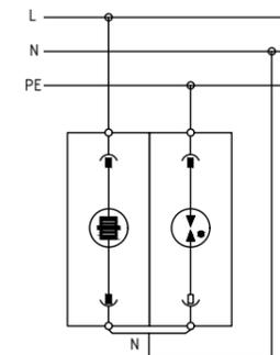
Система заземления TT
