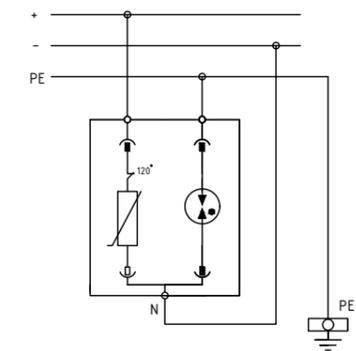
Устройство защиты от импульсных перенапряжений (УЗИП) комбинированного типа РИФ-Э-II 110=/20 предназначено для защиты оборудования в цепях постоянного тока. УЗИП класса испытаний II состоит из базы и двух сменных рабочих модулей. Рабочими элементами устройства являются варистор и газонаполненный разрядник. Рабочий модуль ограничивающего типа снабжен тепловым расцепителем и индикатором состояния. Конструктивное исполнение УЗИП предусматривает установку на стандартную DIN-рейку.
