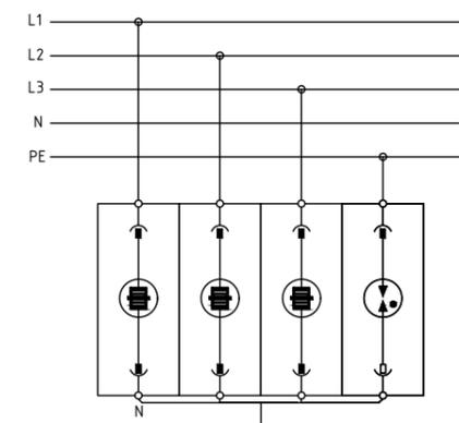
Система заземления TT
