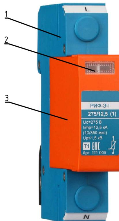
Устройство защиты от импульсных перенапряжений (УЗИП) ограничивающего типа РИФ-Э-1 275/12,5 с (1) предназначено для защиты оборудования в низковольтных цепях до 1000 В от вторичных воздействий молнии, электромагнитных наводок и коммутационных перенапряжений. Применяется в любых системах заземления. Однополюсное УЗИП класса испытаний I состоит из базы и сменного рабочего модуля. Конструктивное исполнение УЗИП предусматривает установку на стандартную DIN-рейку.
