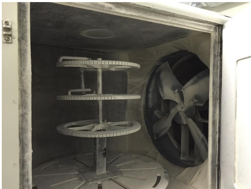
Рис. 11. Испытания экранов РМКЭ-35 в камере пыли.
