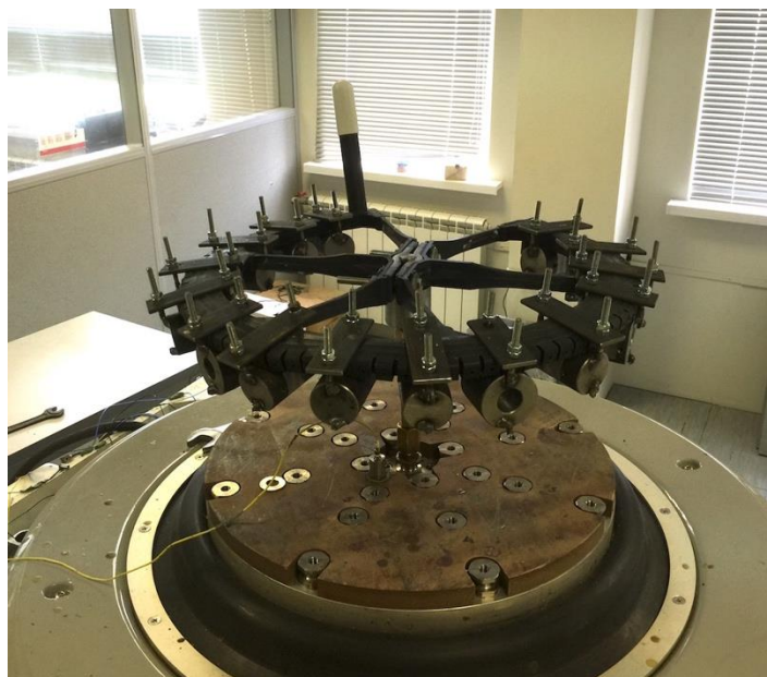
Рис. 10. Испытания экрана РМКЭ-35 на вибропрочность с распределённой нагрузкой 11 кг.
