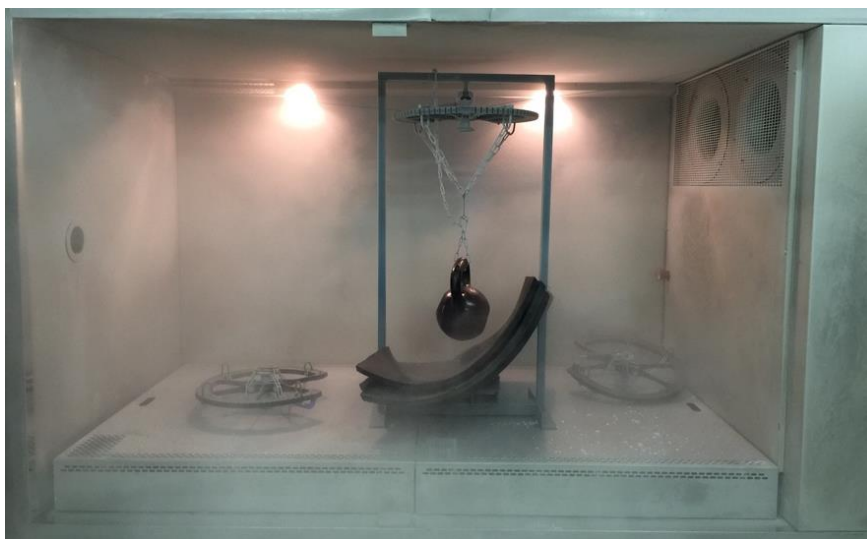
Рис. 9. Испытания экрана РМКЭ-35 в термокамере с распределённой нагрузкой 24 кг.
