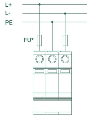
УЗИП в монолитном корпусе
