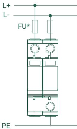
УЗИП в монолитном корпусе
