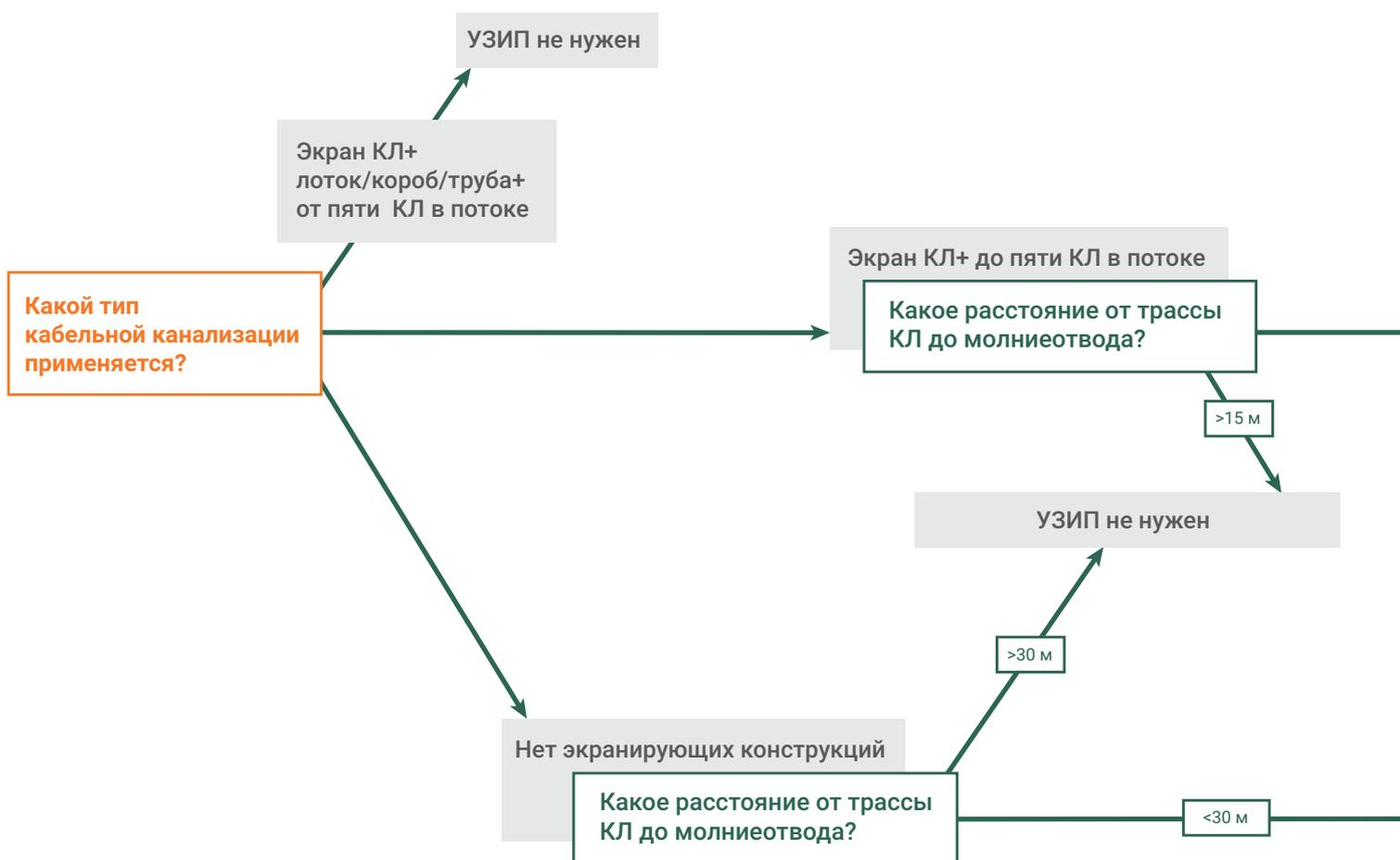
С помощью **алгоритма В** от наведенных (индуктированных) перенапряжений защищается оборудование, питающие линии 0,4 кВ которого проходят вблизи молниеотводов на открытой территории объекта. Типичными примерами таких объектов являются промышленные предприятия, аэропорты, заправочные станции, компрессорные станции, ОРУ подстанций (**рисунок 20**).
