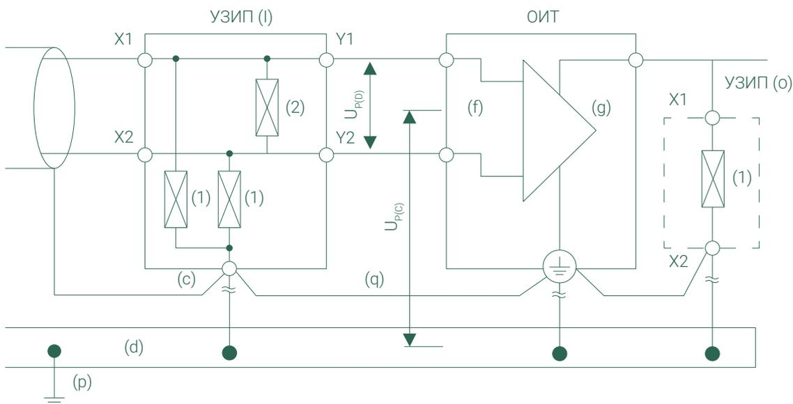
**Рис. 24.** – Пример защиты ОИТ со стороны питания (g) и передачи данных (f)
