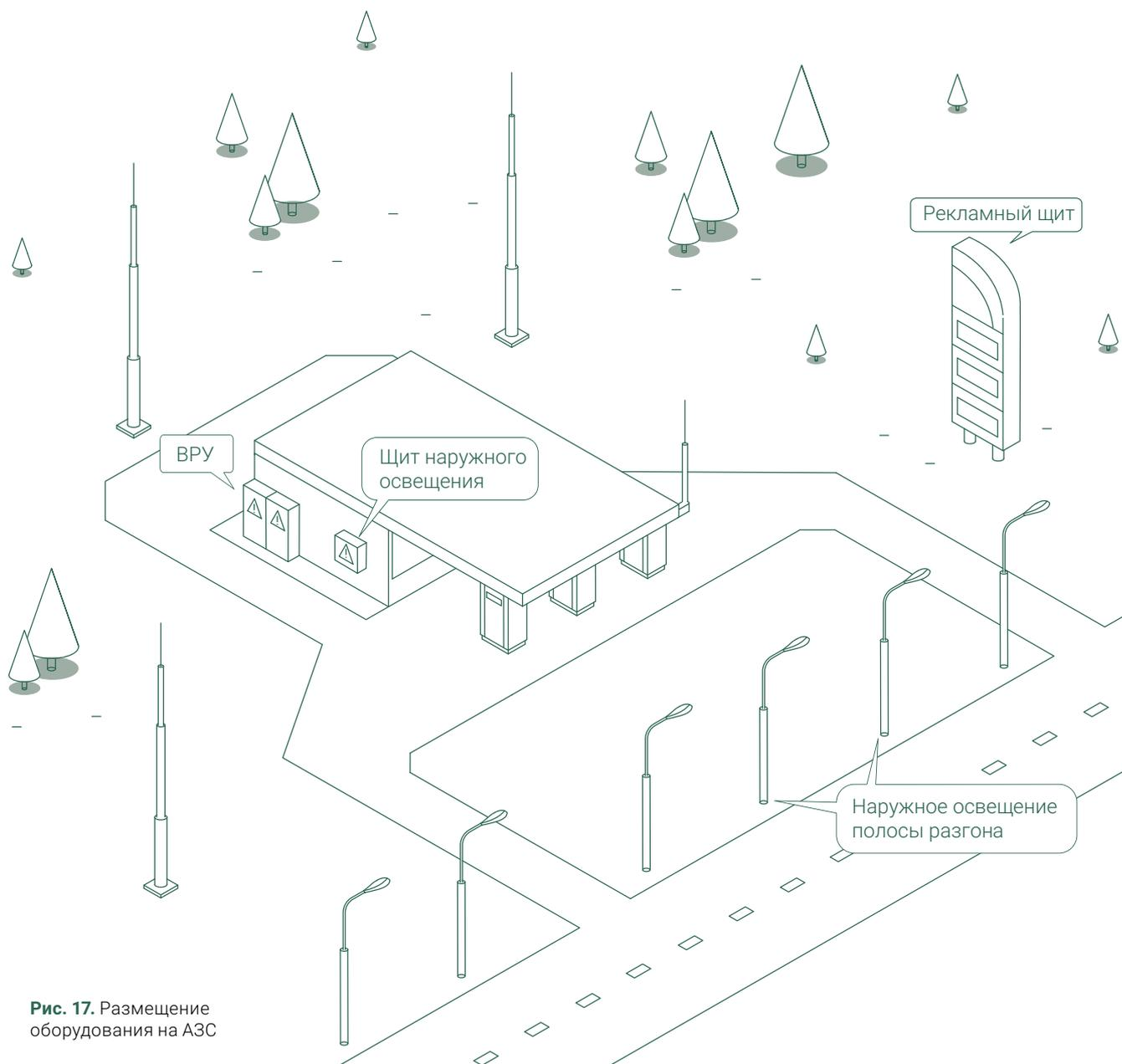
**Рис. 17.** Размещение оборудования на АЗС
