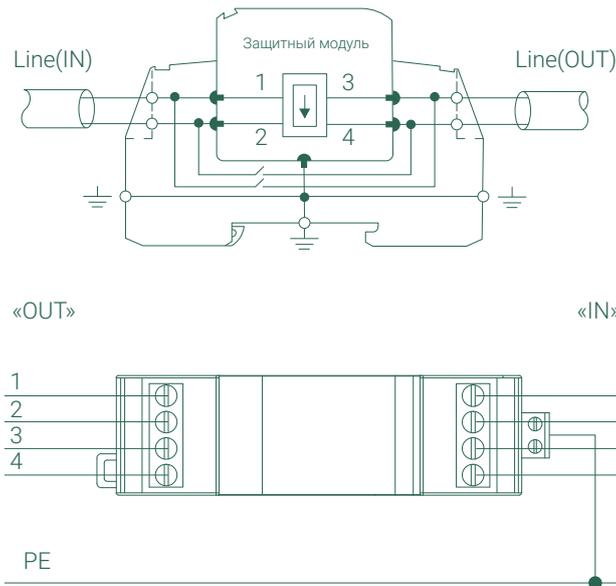
**Рис. 27.** Подключение информационных УЗИП в разрыв линии
