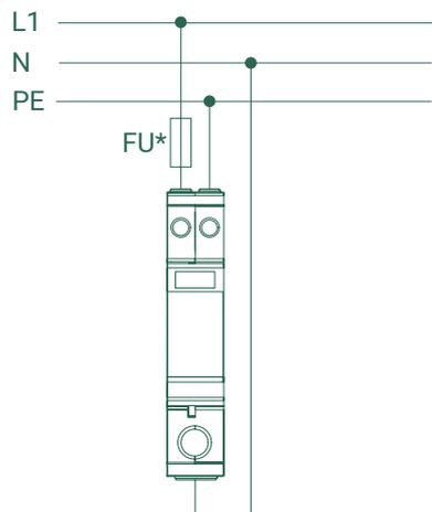
УЗИП в монолитном корпусе
