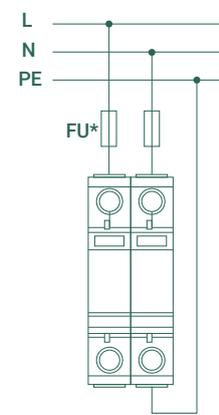
УЗИП в монолитном корпусе
