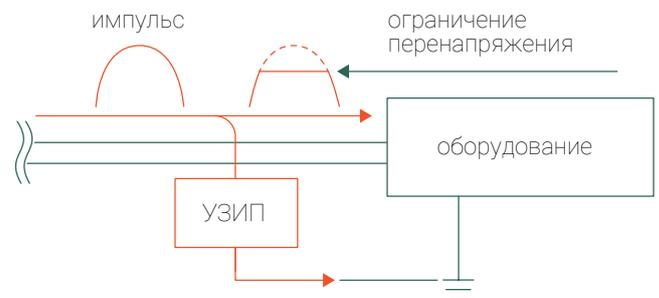
УЗИП защищает участок сети ограниченной длины, которая определяется параметрами волны воздействующего перенапряжения и типом кабельной линии.
