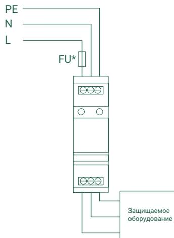
УЗИП в монолитном корпусе
