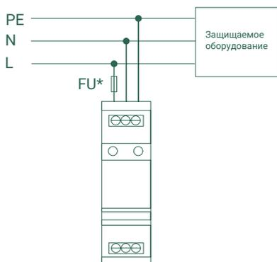
УЗИП в монолитном корпусе
