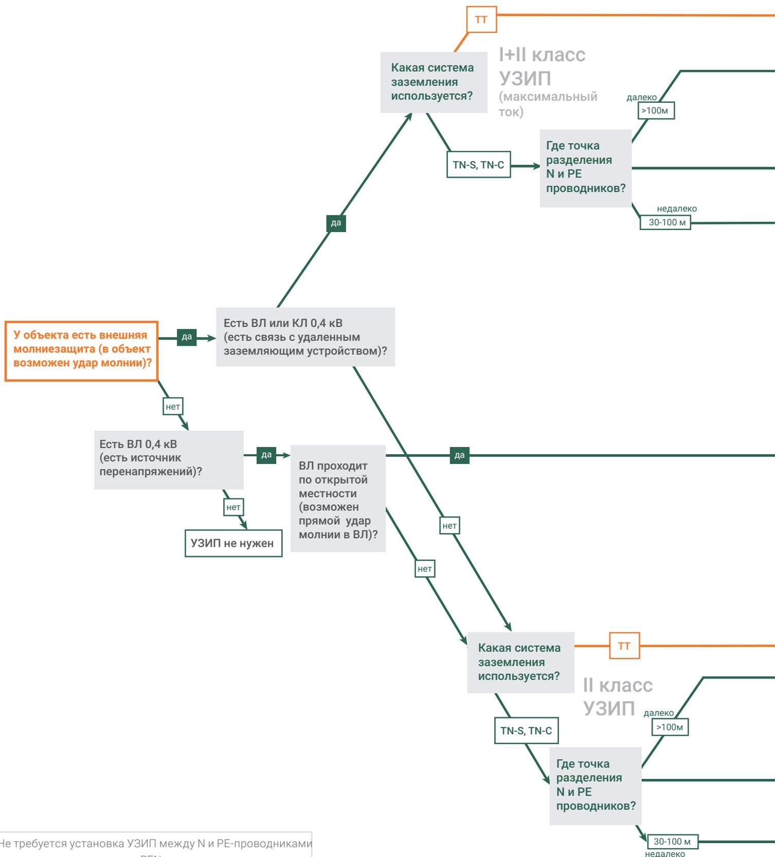
Не требуется установка УЗИП между N и PE-проводниками в случае, если разделение PEN-проводника выполнено в непосредственной близости от места установки УЗИП.
