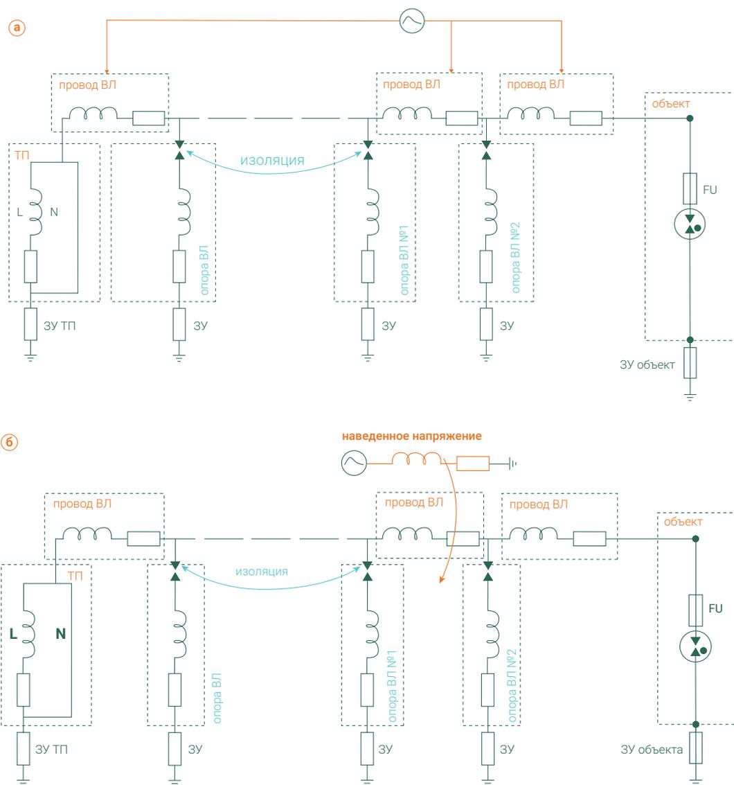
**Рис. 14** Схемы замещения для оценки токов через УЗИП при отсутствии у объекта системы молниезащиты и наличии отходящей ВЛ 0,4 кВ
