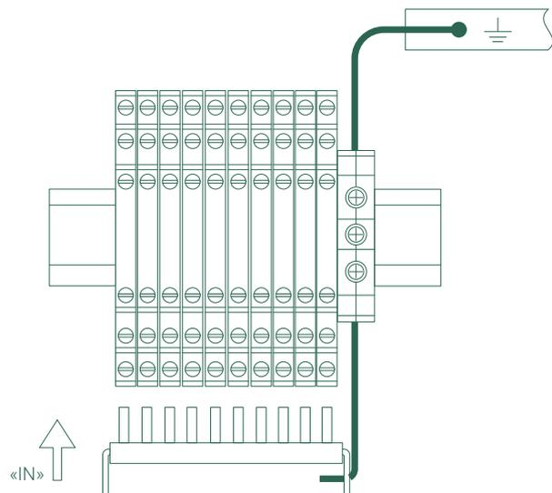
**Рис. 30.** Заземление группы УЗИП с помощью медного шинпровода
