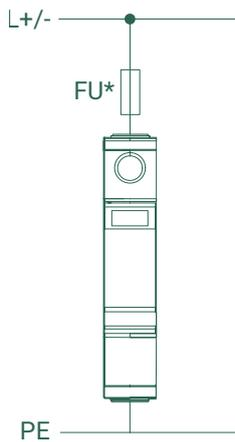
УЗИП в монолитном корпусе
