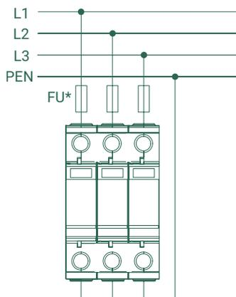
УЗИП в монолитном корпусе
