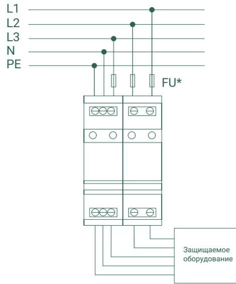
УЗИП в монолитном корпусе
