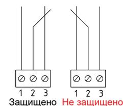
Схема подключения DC для УЗИП с  $U_n=600$  В и  $1000$  В DC
