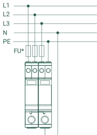
УЗИП в монолитном корпусе
