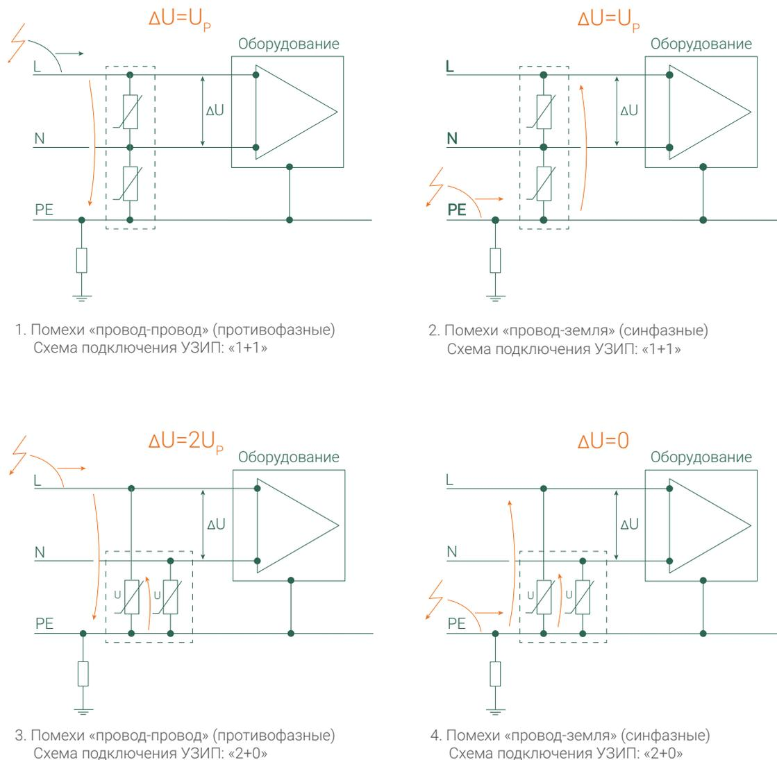
**Рис. 16.** Эффективность работы УЗИП в схемах подключения для защиты от противофазных «1+1» и синфазных «2+0» перенапряжений (упрощенно оценен уровень остаточного напряжения  $U_p$ , приложенного к изоляции оборудования L/N)
