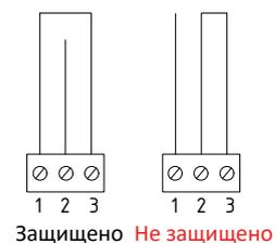
Схема подключения DC для УЗИП с  $U_n=24 - 220$  В DC
