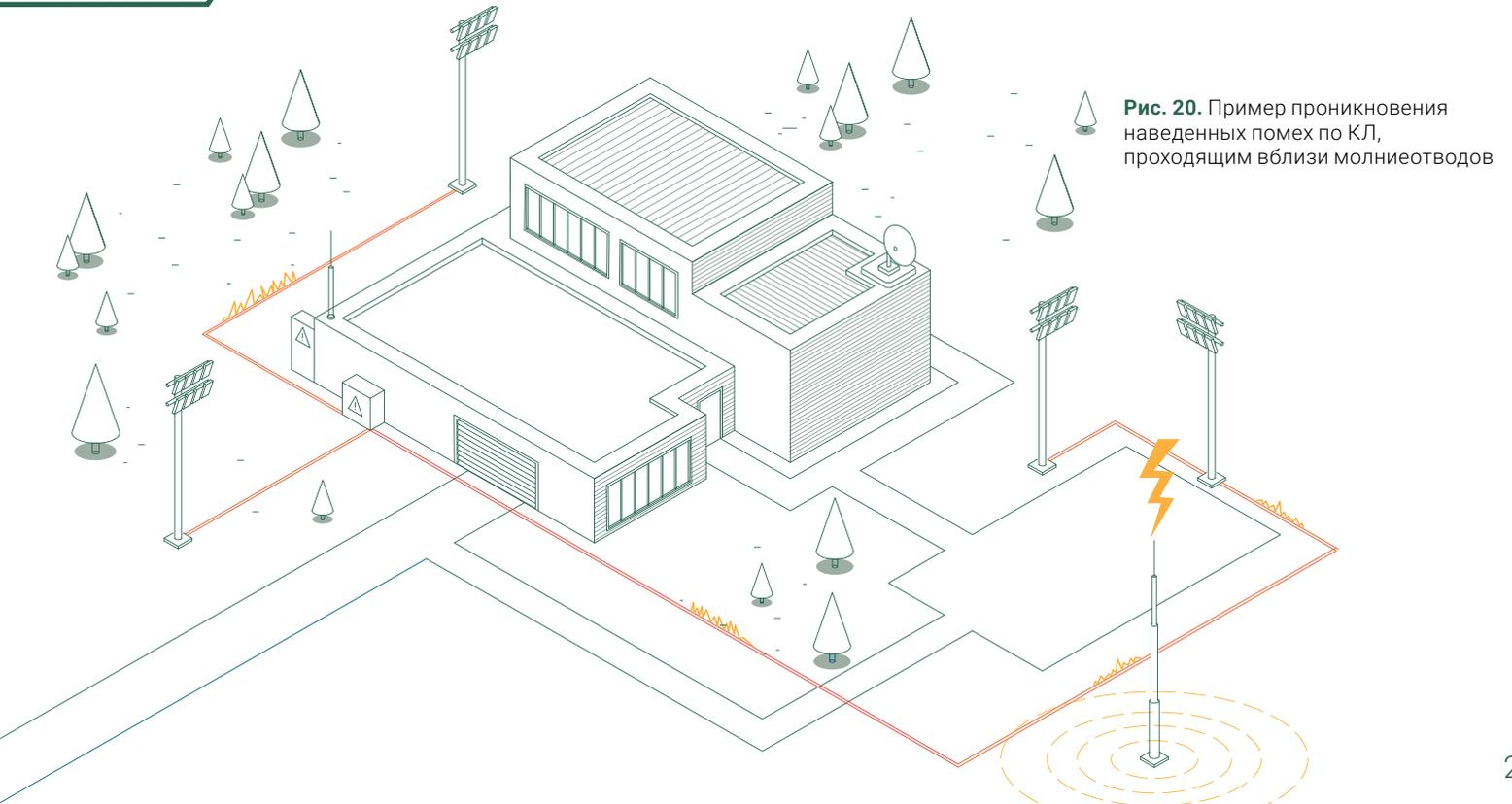
**Рис. 20.** Пример проникновения наведенных помех по КЛ, проходящим вблизи молниеотводов
