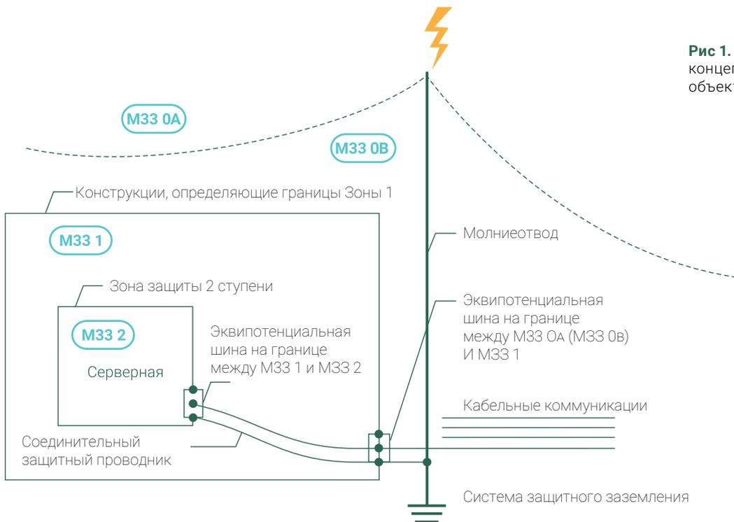
**Рис 1.** Применение зонной концепции молниезащиты объекта
