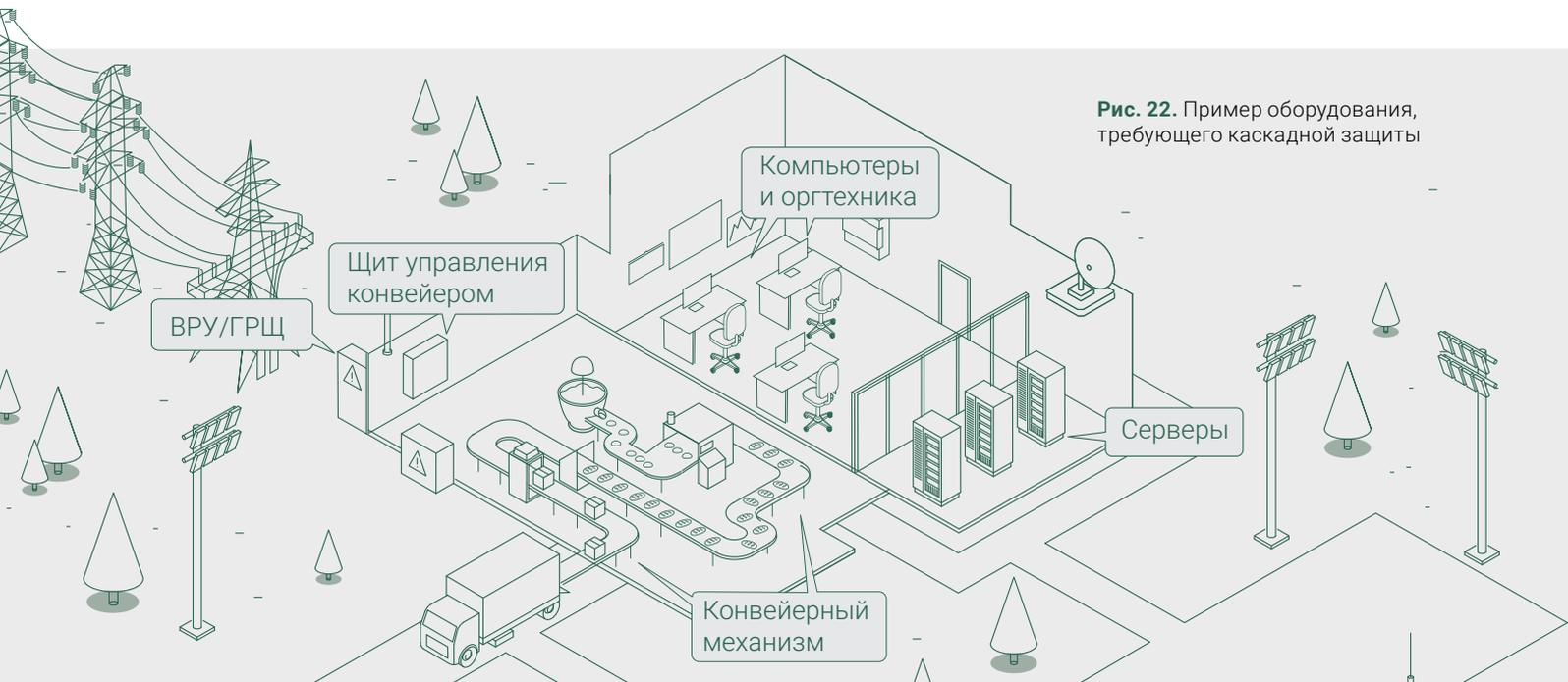
Рис. 22. Пример оборудования, требующего каскадной защиты
