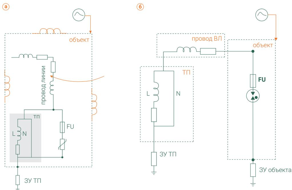
**Рис. 13** Схемы замещения для оценки токов через УЗИП при наличии у объекта системы молниезащиты:
