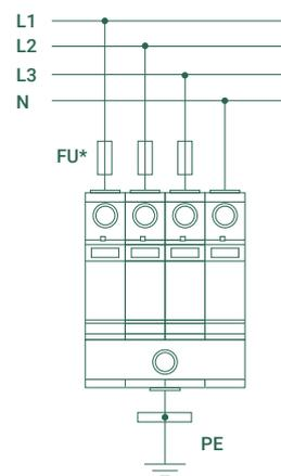
УЗИП в монолитном корпусе
