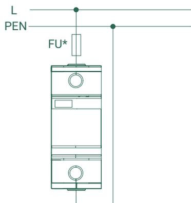
УЗИП в монолитном корпусе
