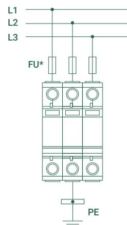
УЗИП в монолитном корпусе
