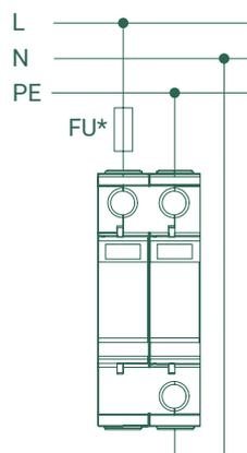
УЗИП в монолитном корпусе
