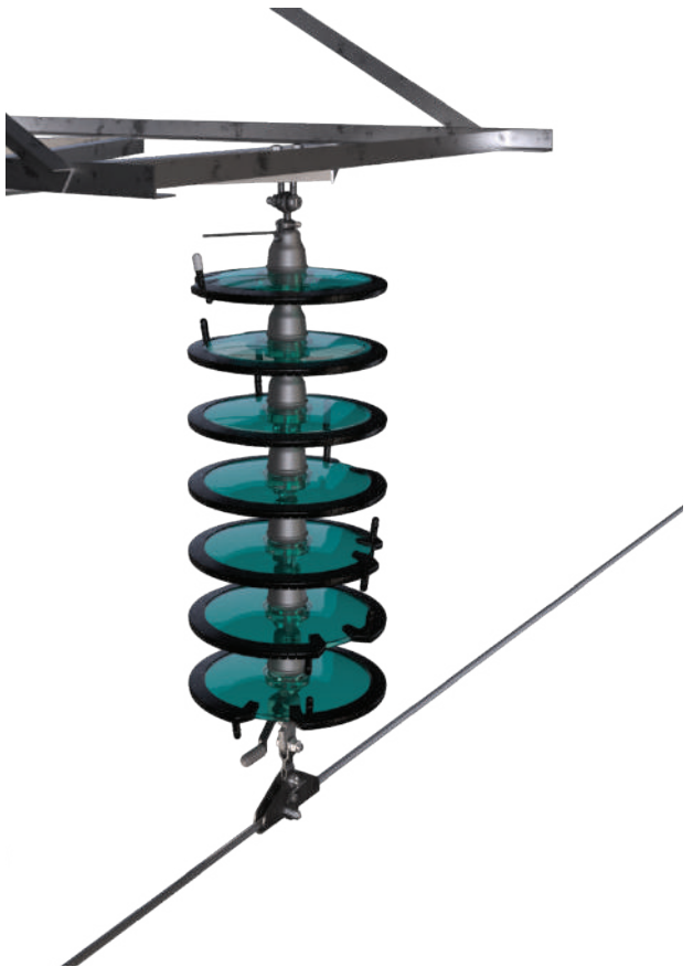
Рис. 25. Установка гирлянды ГИРМК-110 на промежуточной опоре
