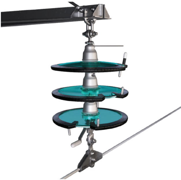
Рис. 22. Установка гирлянды ГИРМК-35 на промежуточной опоре
