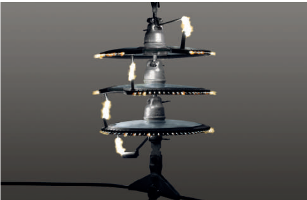
Фото 6. Гирлянды ГИРМК-35 в процессе гашения
