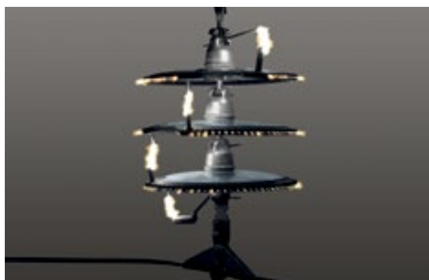
Фото 6. Гирлянды ГИРМК-35 в процессе гашения
